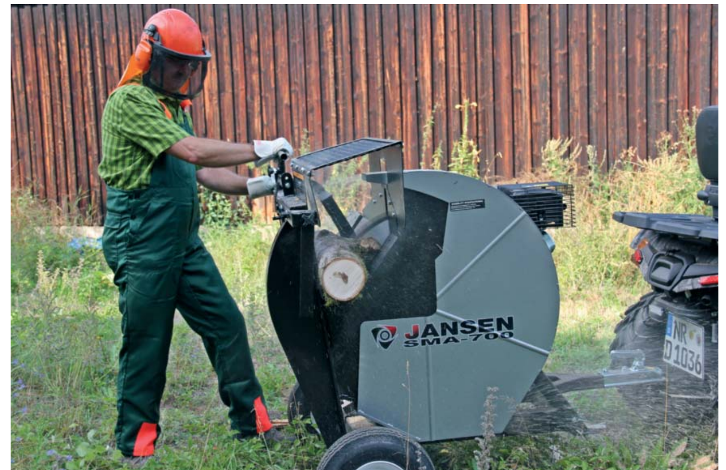
Späneschleuder: Um das Zugfahrzeug nicht einzusauen, besser abkuppeln.
