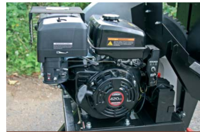
Scheibe mit Muckies: Der Loncin-Motor erzeugt fette 15 PS.
