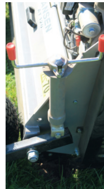
Höhenverstellbar: Auf Böden und Schnittgut anpassbar.
