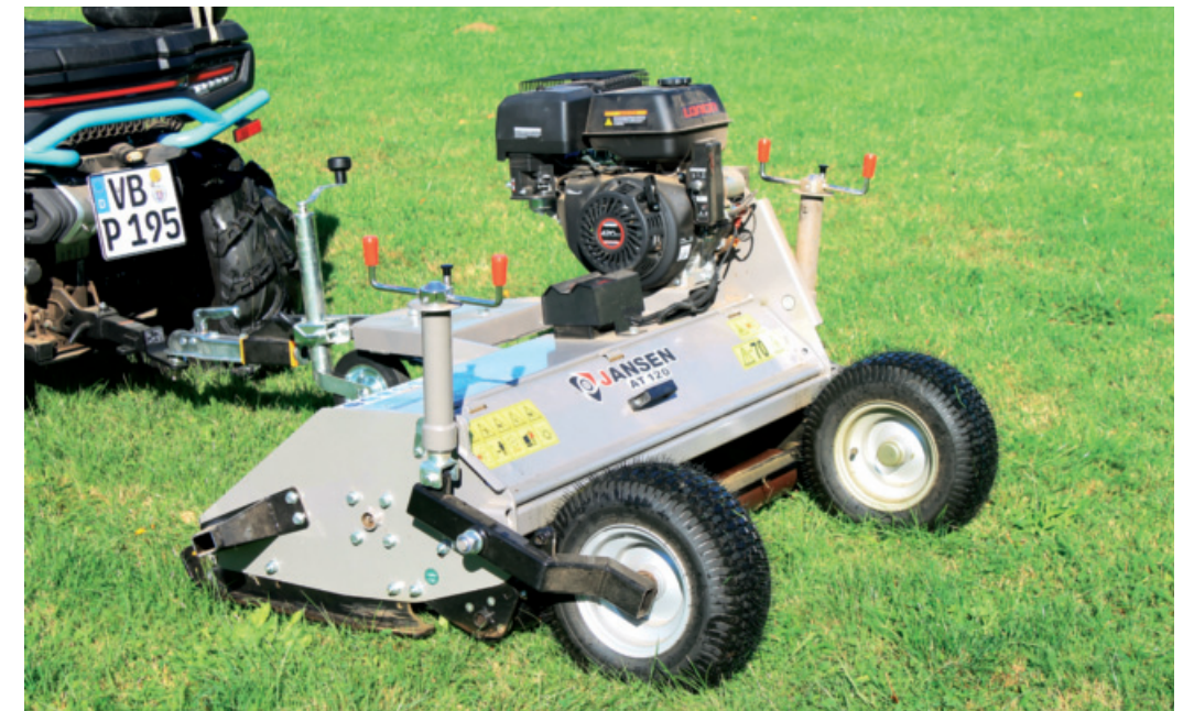
Flexibel: Die Räder lassen sich in verschiedenen Positionen montieren.
