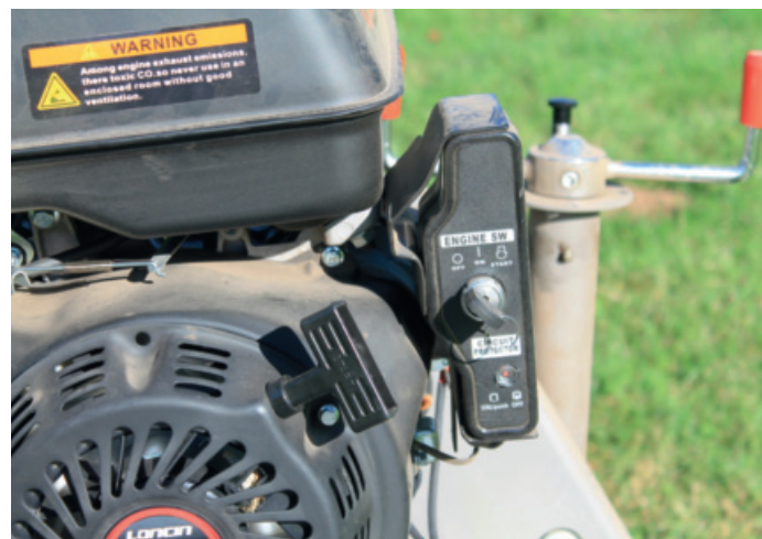
So oder so: Gestartet wird elektrisch oder per Seilzug.
